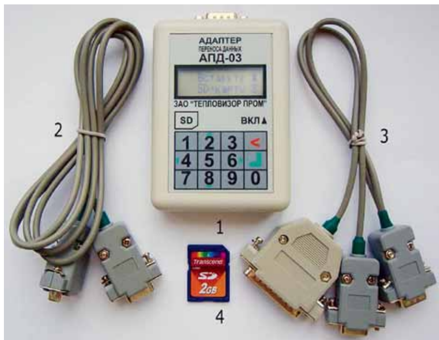
Рис. 2. Комплект поставки адаптера переноса данных АПД-03: 1 – адаптер; 2 – кабель для подключения адаптера к компьютеру или прибору; 3 – переходник; 4 – SD-карта с резервной копией установленной рабочей программы
