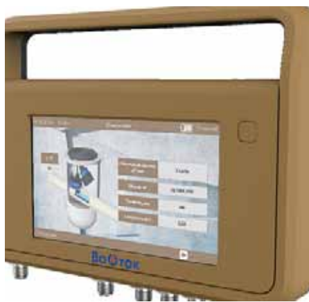
Рис. 1. Расходомер сточных вод «ВоСток»
