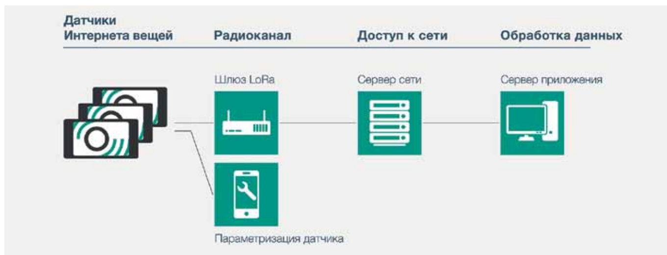
Рис. 2. Схема сети LoRaWAN, построенной на базе решений WILSEN
