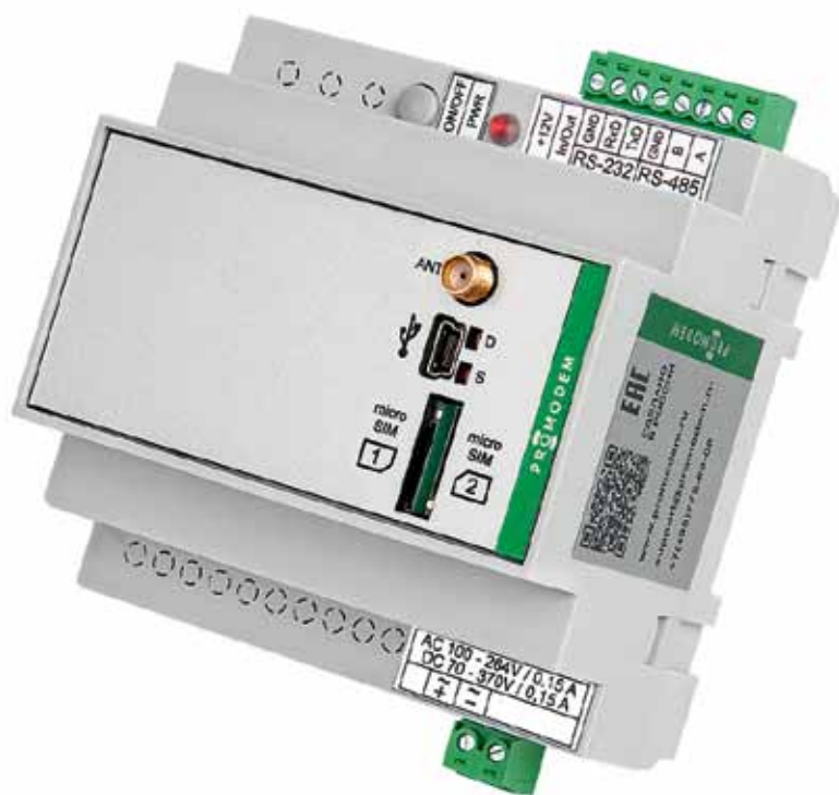
Рис. 1. Промышленный модем PROMODEM GSM с двумя независимыми портами RS-485 + RS-232 и встроенным ИБП на 45 минут автономной работы, температура эксплуатации – от -40 до +60 °C, крепление на DIN-рейку
