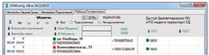
Рис. 7. Вкладка «Таблица соответствия» программы GSMConfig: список модемов, TCP-портов для опроса удаленных устройств, а также индикация и статистика подключений модемов к службе данных PROMODEM GSMService
