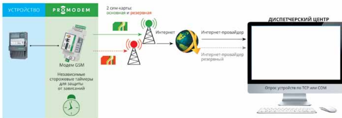
Рис. 2. Автоматический переход на резервного GSM-оператора или на IP-адрес резервного интернет-провайдера для гарантированного подключения модема к серверу
