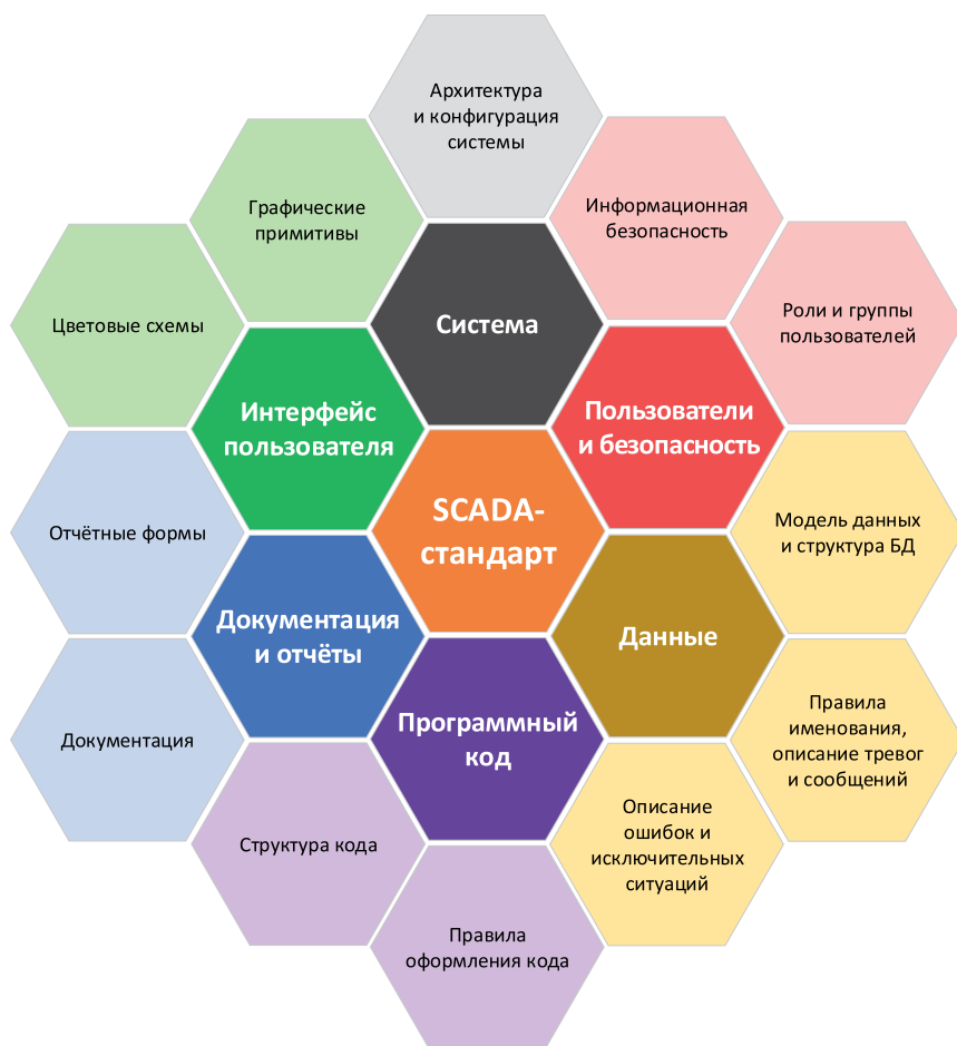
Рис. 2. Объекты и области стандартизации в SCADA-проектах
