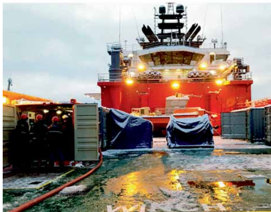
Рис. 2. Контейнер с автоматизированным комплексом ликвидации аварийных разливов нефти и нефтепродуктов на палубе судна (слева)
