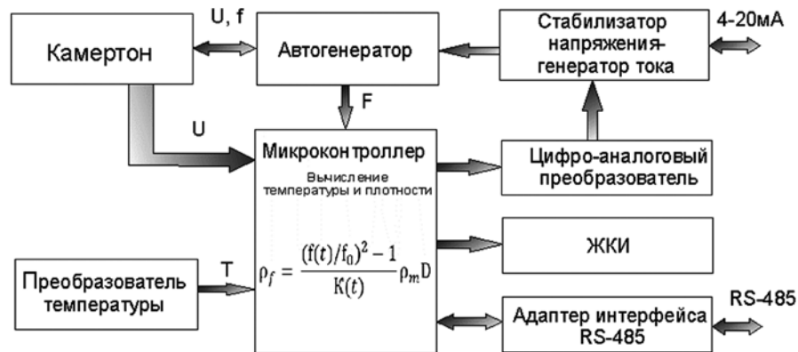
Рис. 3. Блок-схема электронного преобразователя плотномер
