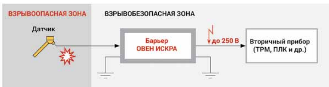
Рис. 4. Схема установки барьера ИСКРА
