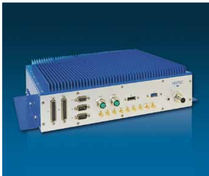
Рис. 7. В основе платформы HeiSys – запатентованная несущая плата для размещения COMExpress и SMARC-модулей, а также слотов m.2
