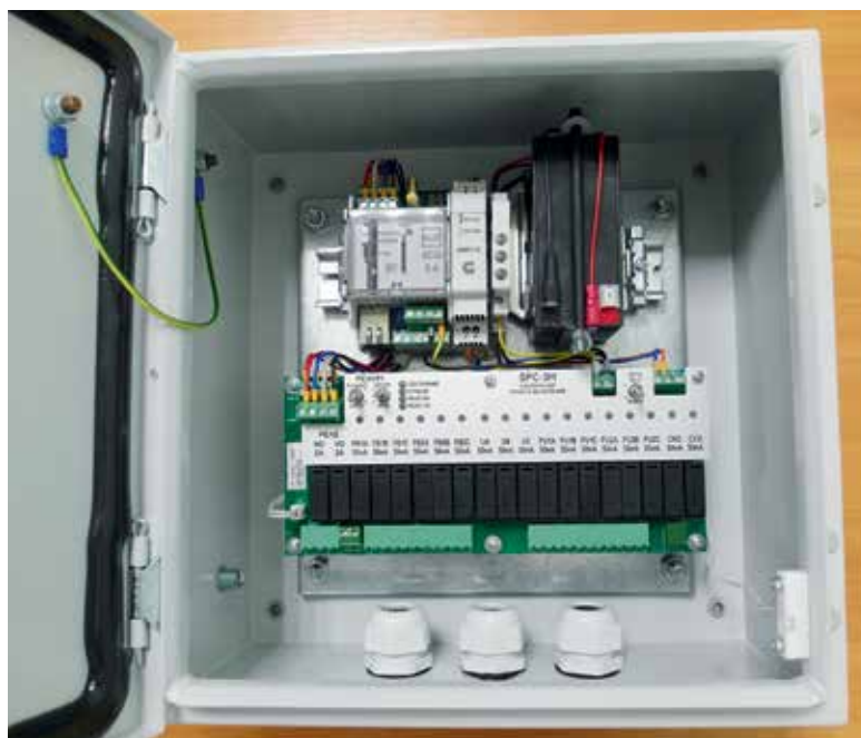
Рис. 2. Контроллер SPC-3M (АСУНО «Луч-2»)
