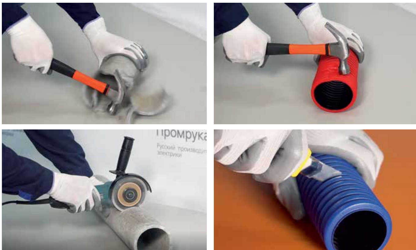
Рис. 2. Сравнительный анализ асбестовых и двустенных гофрированных труб
