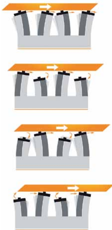
Рис. 2. Четыре этапа работы линейных пьезодвигателей
