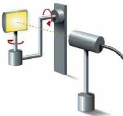
Рис. 3. Гониофотометр: вид А
