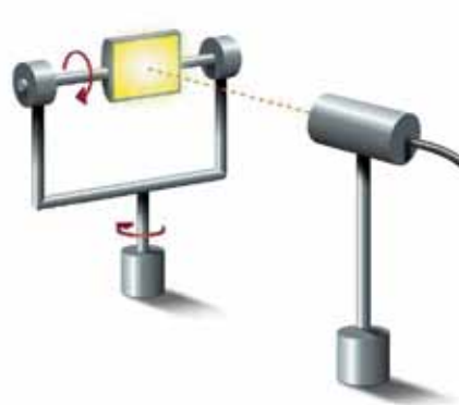
Рис. 4. Гониофотометр: вид В
