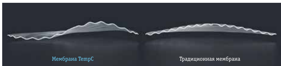
Рис. 4. Деформация традиционной разделительной мембраны и мембраны TempC под воздействием давления
