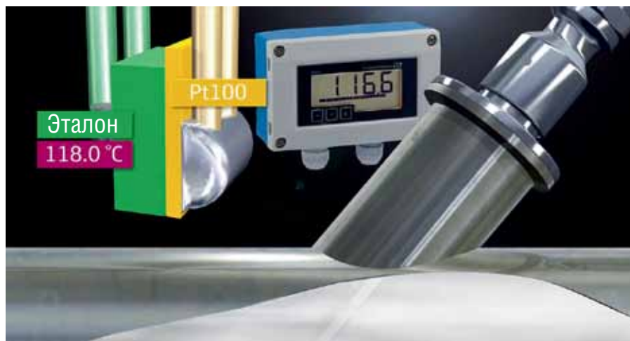
Рис. 2. Сравнение показаний эталона и Pt100 во время рабочего процесса
