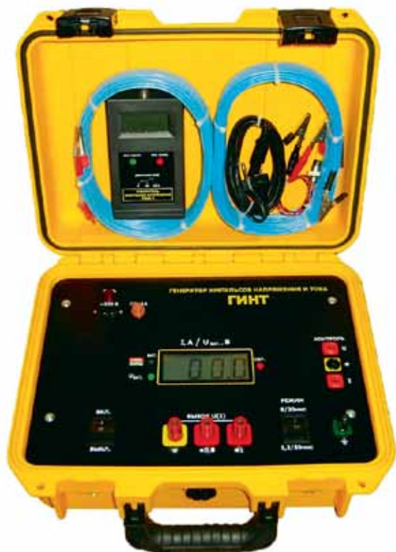
Рис. 1. Комплекс «Гроза-1» для измерения сопротивления заземляющего устройства опор воздушных линий электропередачи
