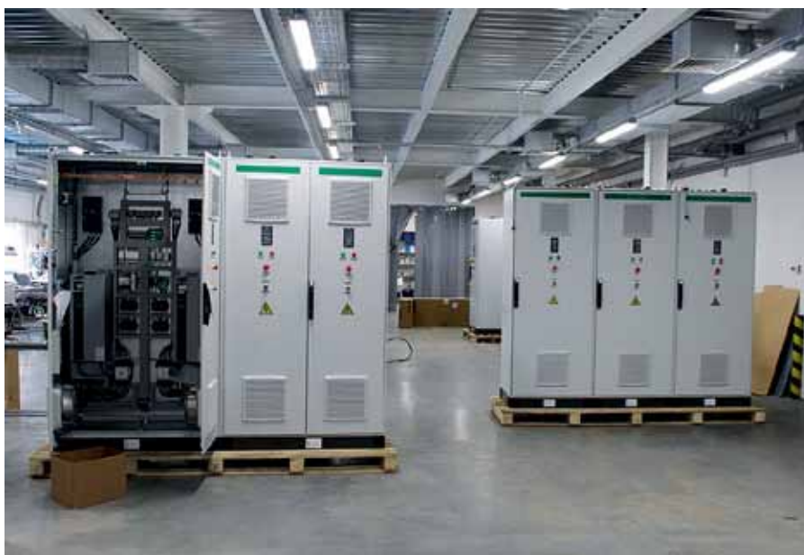
Рис. 1. Сборка шкафов управления на электрощитовом участке производства АО «СИНТО»
