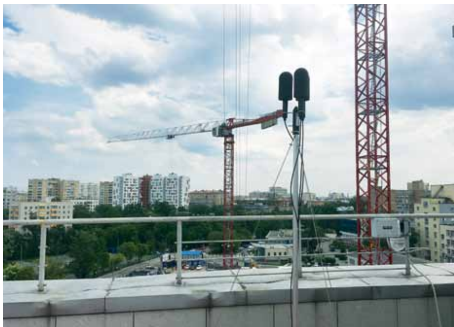
Рис. 3. Октафон-110М: фотография с места стационарной установки
