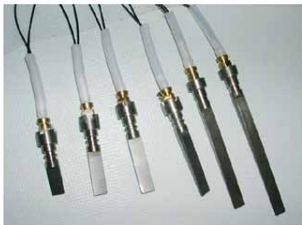
Рис. 3. Внешний вид ДИМ 108М (а) ООО «Пьезоэлектрик» и вихревых счетчиков газа и пара «Ирга-РВ-500» (б) ООО «Глобус» (г. Белгород): ДИМ 108М применяются в вихревых счетчиках газа и пара с условным проходом до 500 мм, не имеющих аналогов в мировой практике
