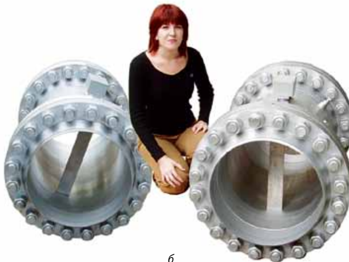
Рис. 3. Внешний вид ДИМ 108М (а) ООО «Пьезоэлектрик» и вихревых счетчиков газа и пара «Ирга-РВ-500» (б) ООО «Глобус» (г. Белгород): ДИМ 108М применяются в вихревых счетчиках газа и пара с условным проходом до 500 мм, не имеющих аналогов в мировой практике
