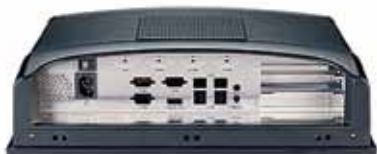
Рис. 2. Все внешние разъемы ввода/вывода находятся в нижней части корпуса PPC-6151C
