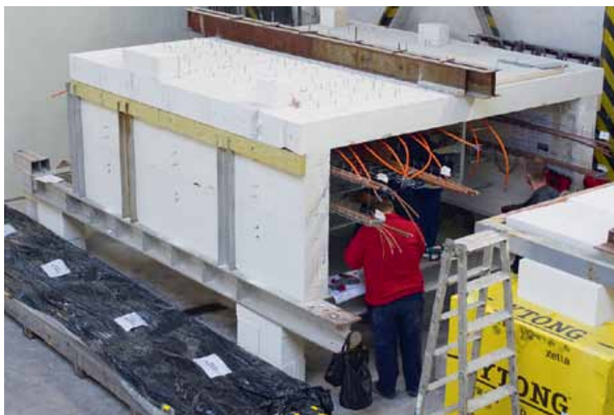
Рис. 4. Испытание огнестойких изделий КОПОС для монолитного строительства
