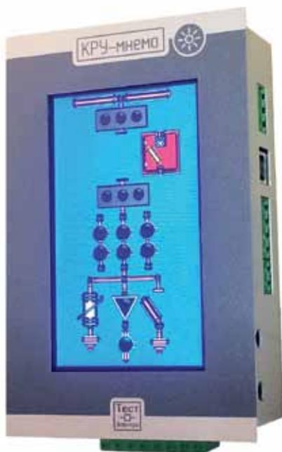
Рис. 3. Модуль индикации мнемосхем «КРУ-мнемо-5»
