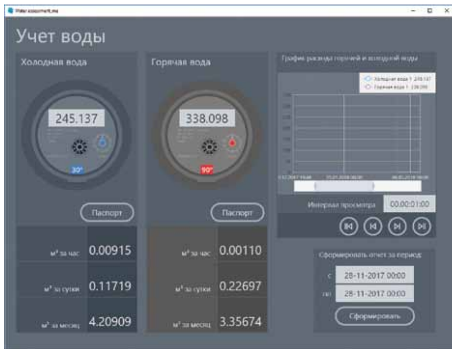
Рис. 3. Графический веб-интерфейс сервиса учета потребления воды, реализованного на MasterSCADA 4D
