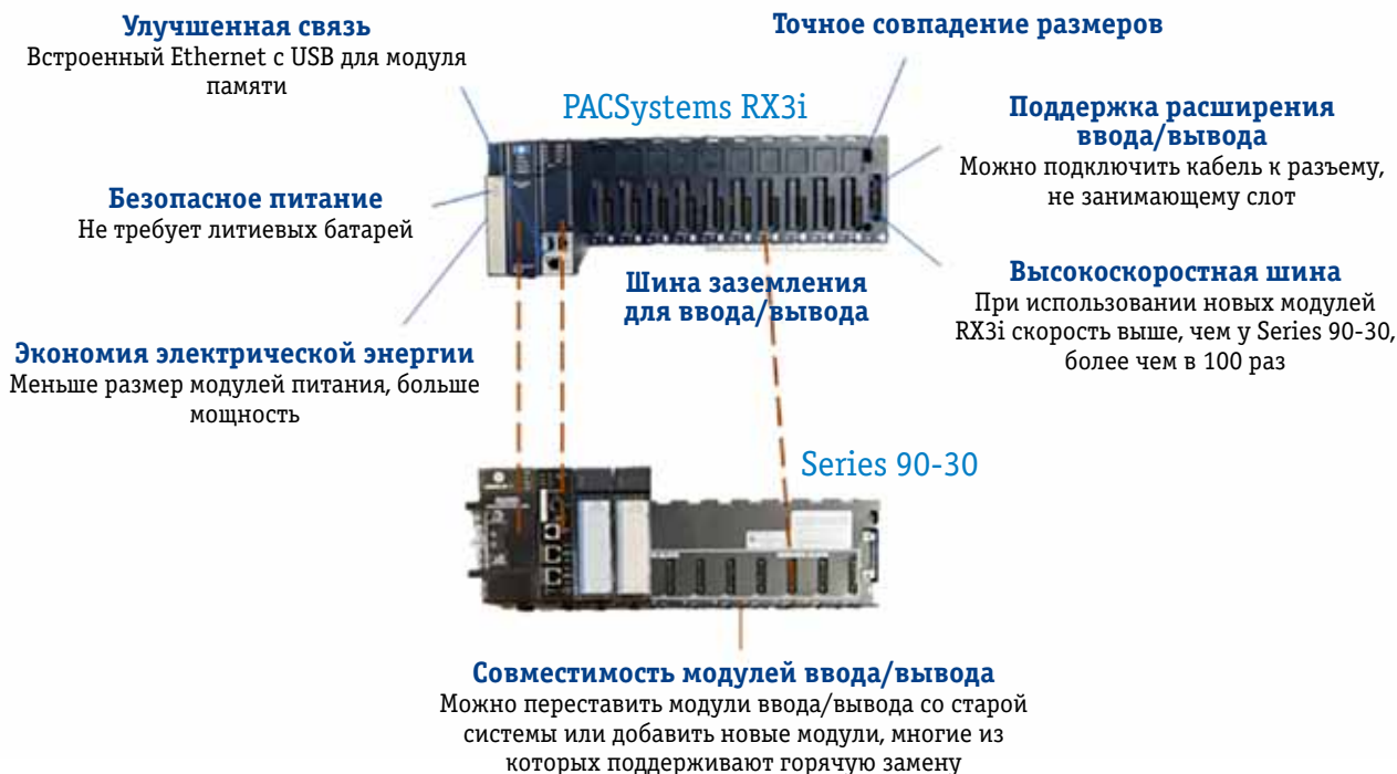
Рис. 1. Модернизация контроллеров Series 90-30
