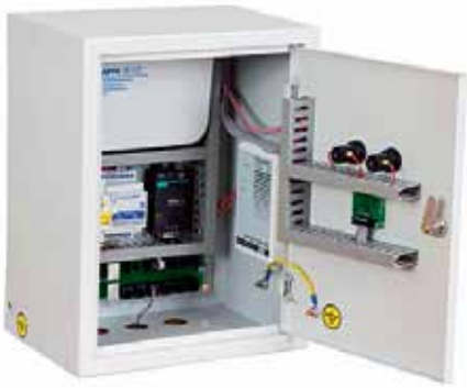
Рис. 2. Модуль системы мониторинга микроклимата: вид внутри
