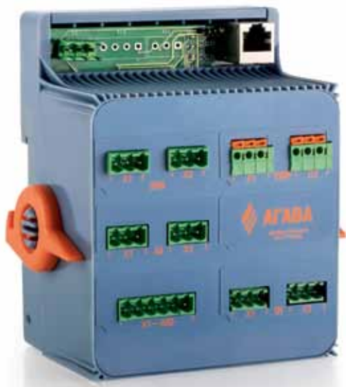
Рис. 2. Базовый блок модуля МВВ-40: задняя и боковая часть корпуса
