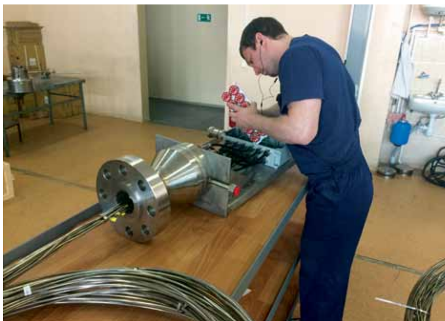
Рис. 2. Сборка многозонных термопар второго поколения
