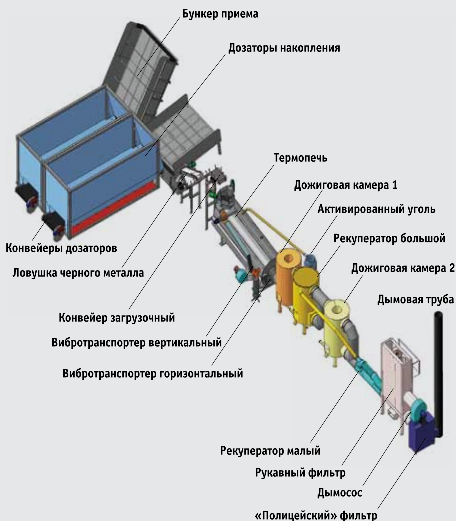
▲ Комплекс термического обезвреживания ТБО
