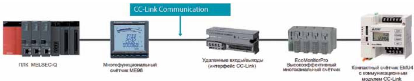
Рис. 6. Включение счетчика EMU4 в сеть
