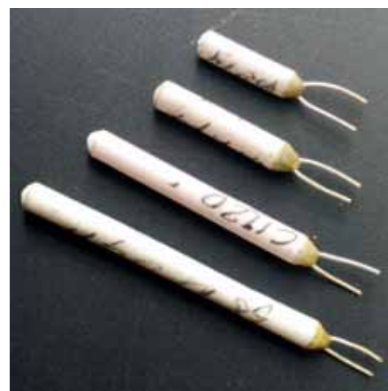
Рис. 1. Проволочный платиновый чувствительный элемент серии ЧЭПТ
