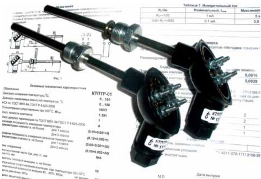
Рис. 2. Комплект термометров платиновых технических разностных серии КТПТР
