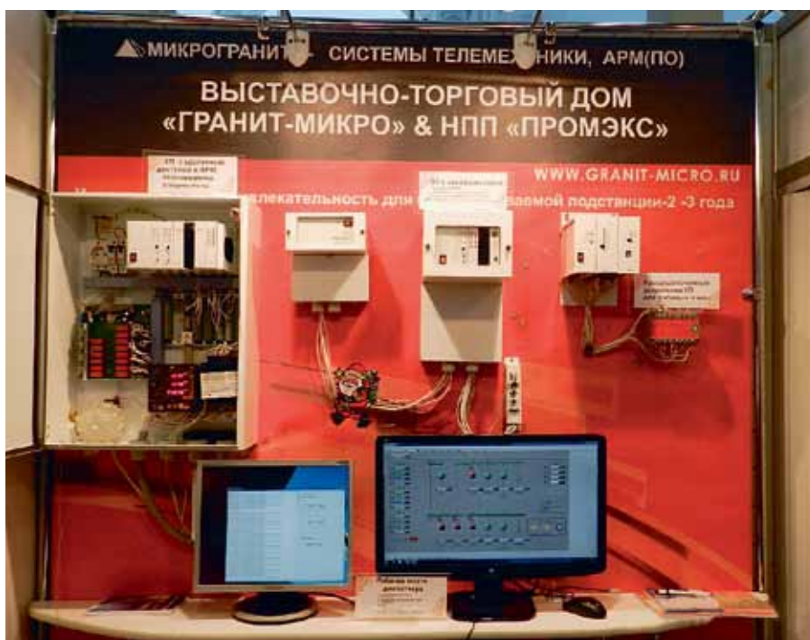
Рис. 2. Система телемеханики «МИКРОГРАНИТ» на выставочном стенде: АРМ оператора, разнообразные типы устройств в роли КП(ПУ) с удаленным доступом и различными каналами связи (в том числе рассредоточенное устройство КП для силовых ячеек) и пр.
