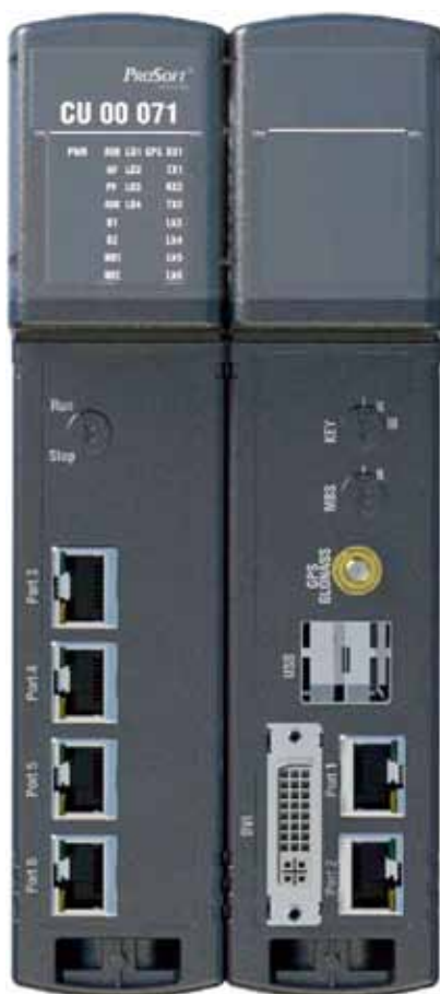
Рис. 2. Коммуникационные возможности модуля центрального процессора CU 00 071
