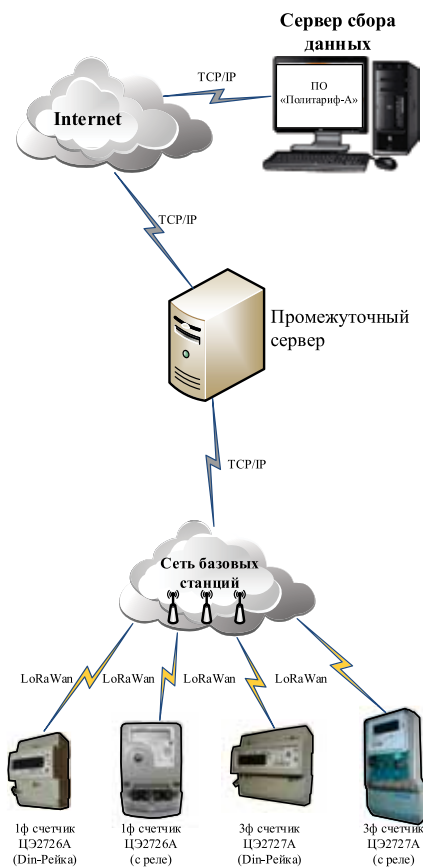
▲ Структура системы сбора данных, построенной на основе технологии LoRaWAN
