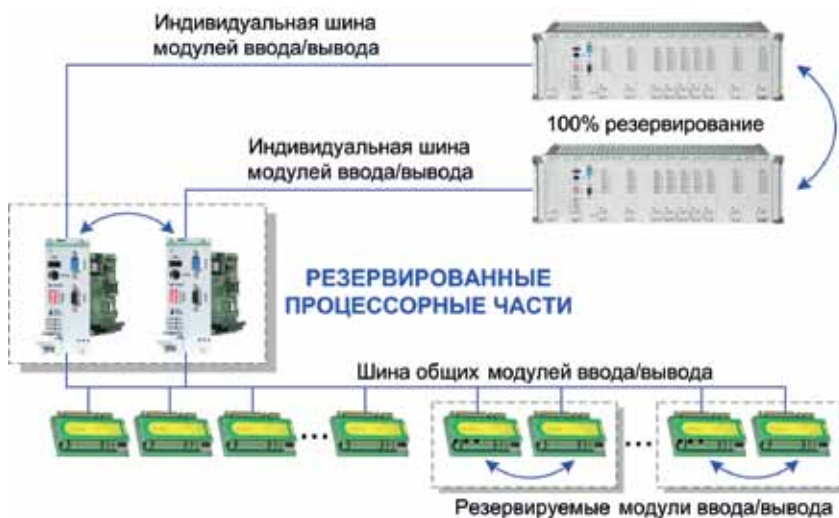
Рис. 2. Схема резервирования контроллеров
