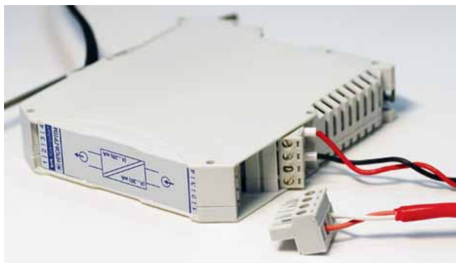
Рис. 6. Подключение внешних линий с помощью разъёмных клеммных соединителей
