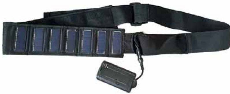
Рис. 2. Ошейник-трекер для крупных животных Cow Collar GPS Tracker T500
