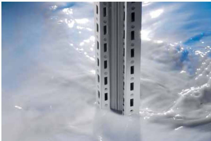
Рис. 2. Грунтование каркаса распределительного шкафа методом погружения на заводе Rittal в Риттерсхаузене
