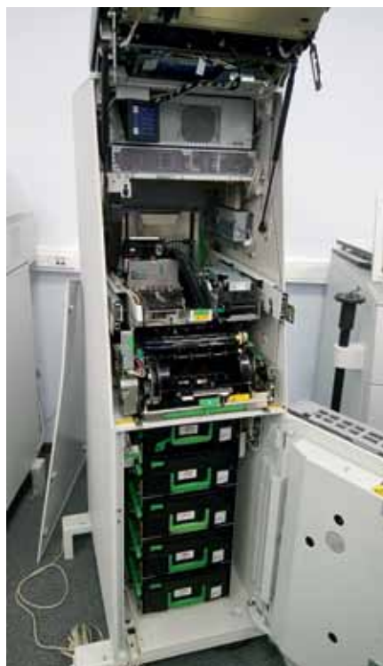
▲ Банкомат просто насыщен электроникой, которая требует соблюдения температуры и отсутствия конденсата
