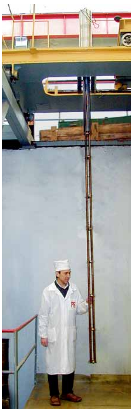
Рис. 3. 24-точечный сигнализатор уровня теплоносителя ядерного реактора
