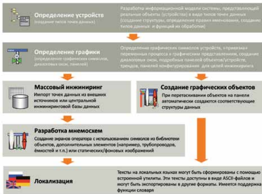
Рис. 1. Типовой процесс создания проекта WinCC OA
