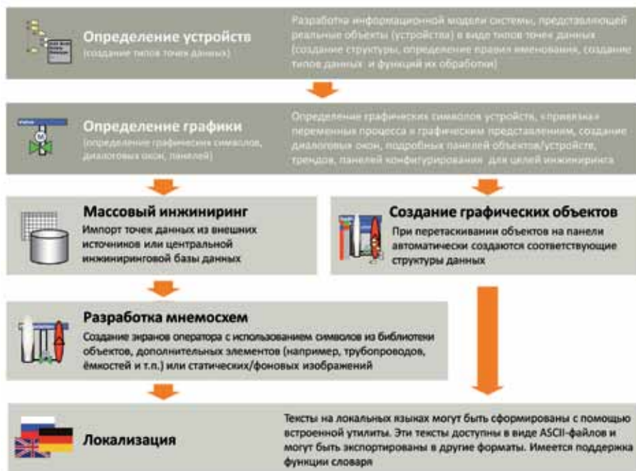
Рис. 1. Типовой процесс создания проекта WinCC OA
