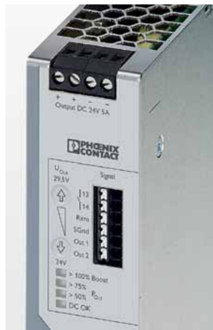
Рис. 2. Блок питания серии QUINT4: передняя панель
