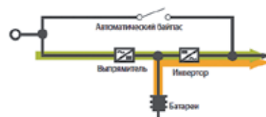
Рис. 4. Топология двойного преобразования (онлайн)
