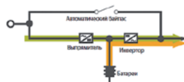
Рис. 4. Топология двойного преобразования (онлайн)
