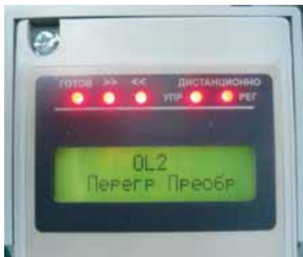
Рис. 3. Сообщение на дисплее EI-7011 при токовой перегрузке преобразователя
