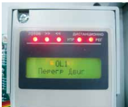
Рис. 2. Сообщение на дисплее преобразователя частоты EI-7011 при токовой перегрузке управляемого электродвигателя
