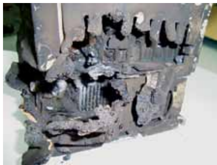
Рис. 1. Вверху — повреждение кристаллов IGBT; внизу — внешний вид вышедшего из строя преобразователя частоты
