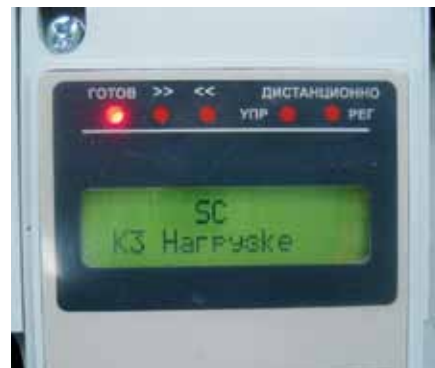
Рис. 4. Сообщение на дисплее EI-7011 при коротком замыкании в нагрузке
