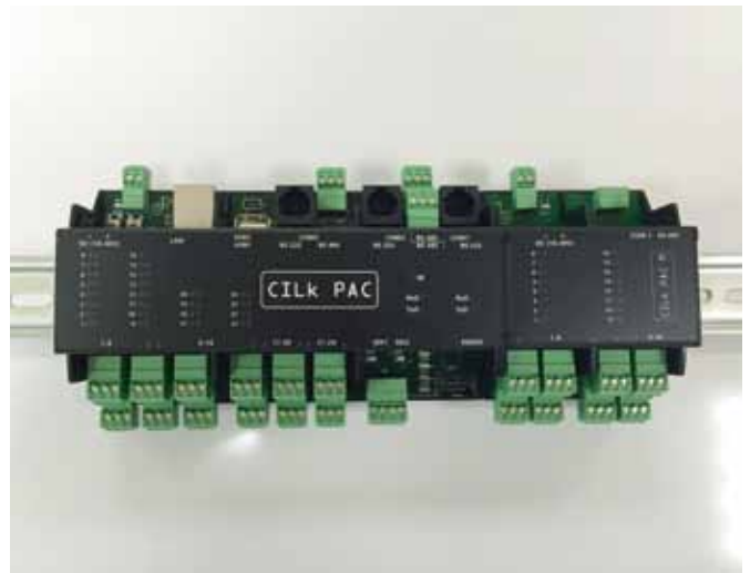
▲ Контроллер CILK PAC на DIN-рейке: благодаря соединителю HBUS модуль расширения устанавливается быстро и легко
