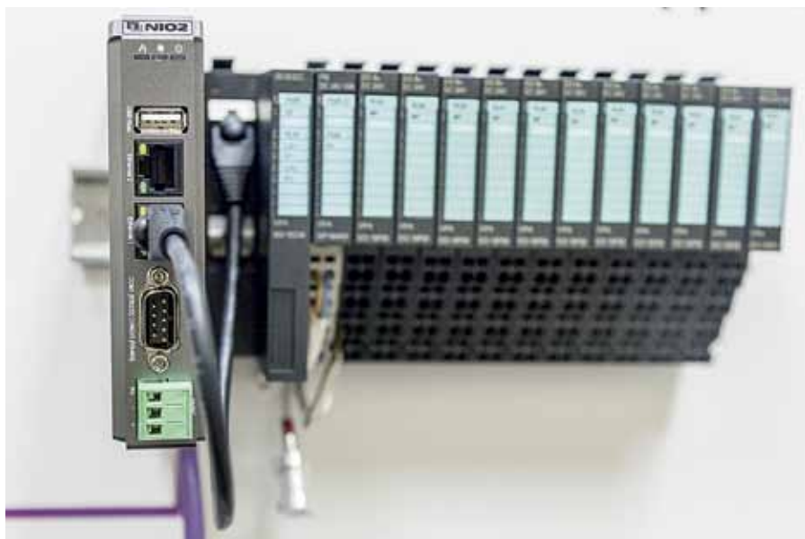
Рис. 2. Контроллер NIO2, подключенный к модулям ввода/вывода через интерфейс EtherCAT
