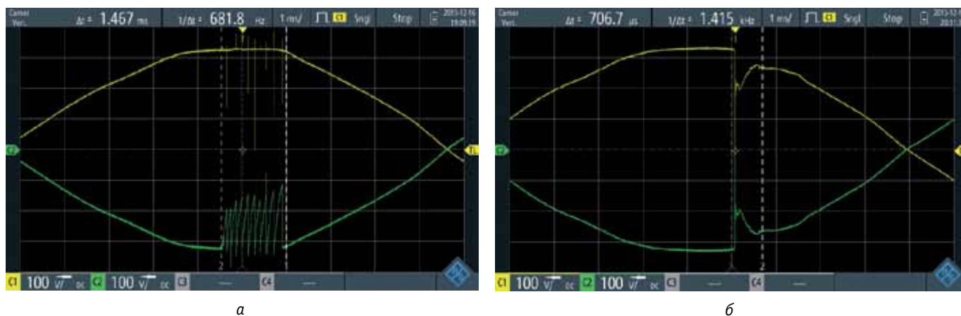
Рис. 2. Результаты измерений: а – при отсутствии нагрузки на выходе блока питания; б – при наличии нагрузки на выходе блока питания
