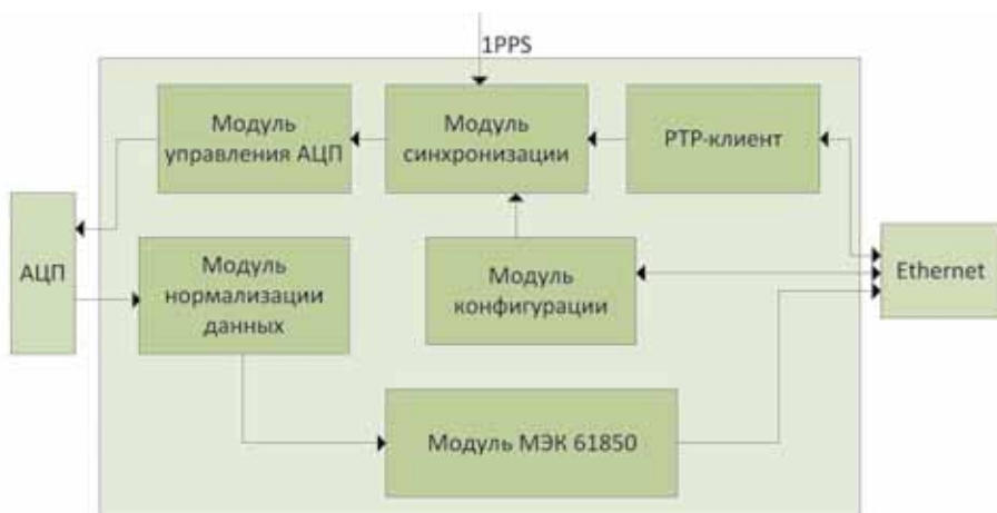
Рис. 3. Алгоритм работы цифровой части УСШ.13
