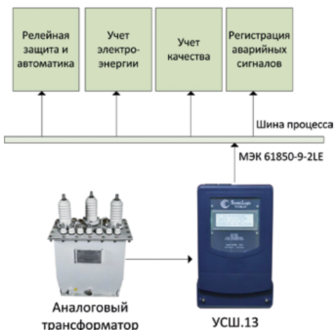
Рис. 4. Схема с использованием аналоговых измерительных трансформаторов
