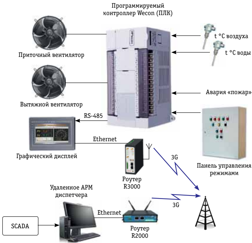
Рис. 2. Коммутация АСУВ с помощью программируемого контроллера Wecon серии LX3v и HMI LEVI777
