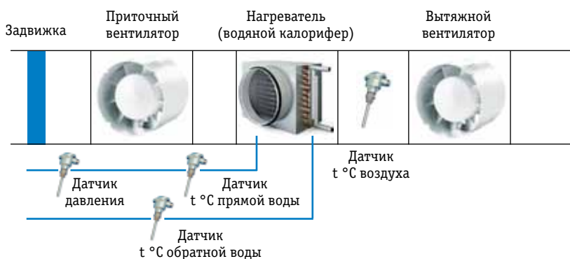
Рис. 1. Общая схема автоматизированной системы вентиляции
