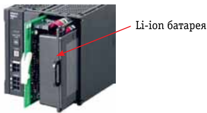
Рис. 2. Замена батареи в ИБП без прекращения подачи питания
