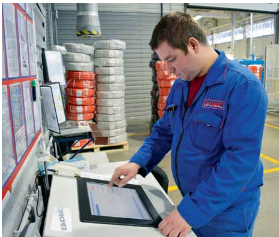
Рис. 4. У каждого сотрудника, который работает с MES-системой, есть своя учетная запись, через которую он с помощью считывания с карты входит в промышленный компьютер
