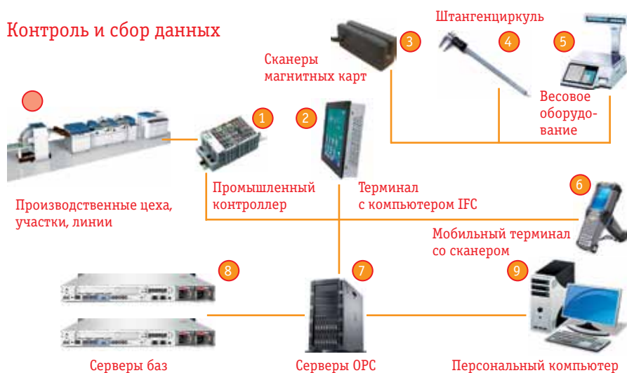
Рис. 1. Система MES охватывает 56 производственных линий: в общую сеть объединены промышленные контроллеры (отмечены цифрой «1»), специальные терминалы с промышленными компьютерами IFC («2»), в том числе мобильные («6»), сканеры магнитных карт («3»), измерительные приборы – электронные штангенциркули («4»), весовое оборудование («5»), серверы OPC («7»), базы данных («8») и ПК («9»)
