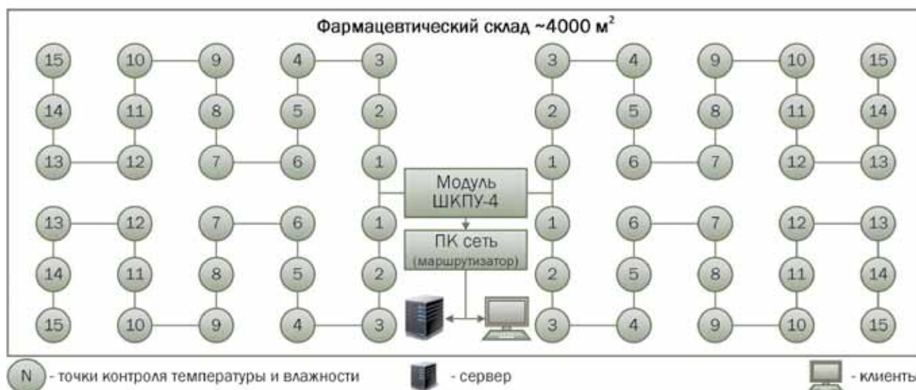
Рис. 4. Организация автоматизированной системы сбора и контроля температуры и относительной влажности на крупном фармацевтическом складе с использованием одного модуля ШКПУ-4 (до 60 датчиков)
