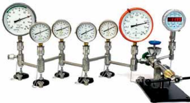
Рис. 4. Коллектор КС с манометрами, присоединенный к прессу для создания давления
